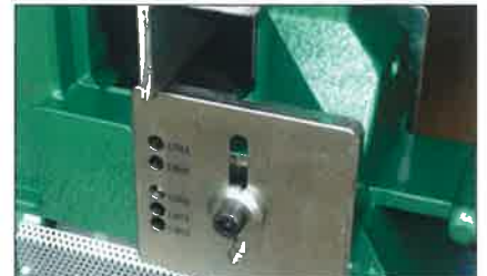
スーパーベンダー加工部 (KZ-75B) 誰でも簡単に位置合わせができるガイド 加工精度、作業性が向上
