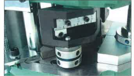
スーパーノッチャー加工部 (KZ-75V) 効果的なガイド、スケール、クランプ 加工精度、作業性が向上
