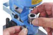
安全ロック機構でダイの緩みを解消します。
